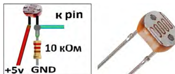
Рис. 4. Схема подключения фоторезистора к Ардуино
