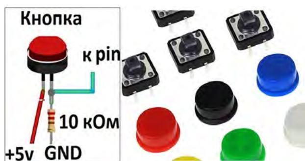
Рис. 1. Схема подключения тактовой кнопки к микроконтроллерной плате
