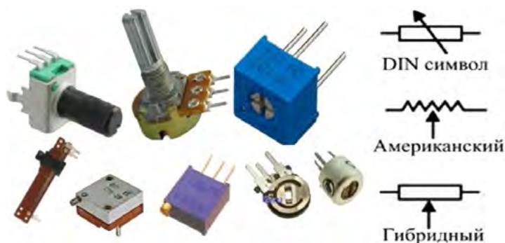
Рис. 10. Переменные резисторы (потенциометры)
